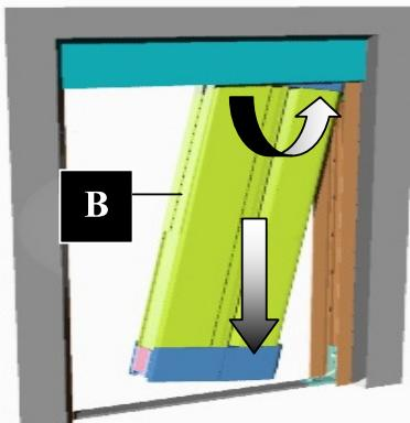
INSERT THE INSECT SCREEN UPPER BOUND, THE SIDE WHERE YOU CAN FIND TWO SCREWS, IN THE TOP TRACK. BRING THE INSECT SCREEN UPPER SIDE NEAR THE LATERAL PROFILE AND THE LOWER BOUND NEAR THE SAME PROFILE, PUSHING DELICATELY THE INSECT SCREEN UPWARDS. WHEN THE CASSETTE IS LAID DOWN ALONG THE LATERAL PROFILE BRING THE INSECT SCREEN DOWN UNTIL THE GUIDE. THE INSTALLATION IS COMPLETE.
